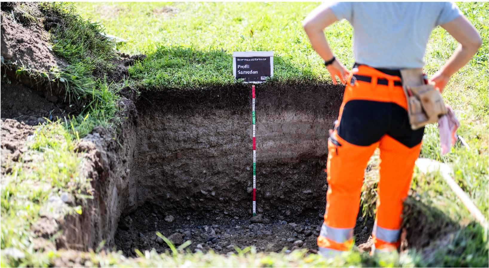
Das «Profil Samedan» im kantonalen Bodenmessnetz ist eine rund eineinhalb Meter tiefe Grube in der Nähe des Flugplatzes in Samedan. Hier untersuchen Spezialistinnen und Spezialisten den Bodenaufbau wie auch die Bodenbeschaffenheit, unter anderem in Bezug auf Trockenheit. Foto: Mayk Wendt
