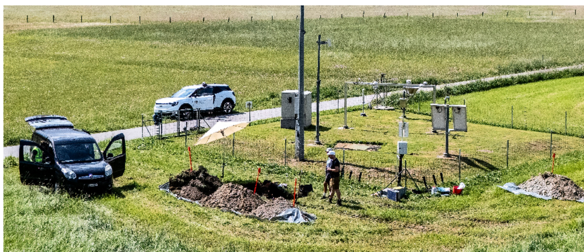
Die Bodenmessstation mit der ausgehobenen Untersuchungsgrube befindet sich beim Flugfeld in Samedan.
